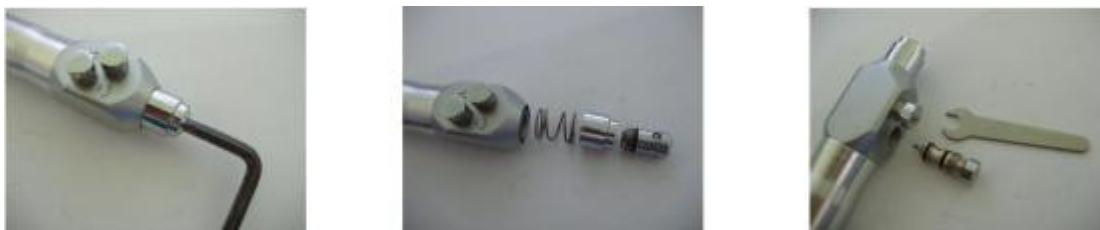
Рис. 28. Разбор прямого пистолета для очистки
