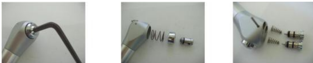
Рис. 27. Разбор углового пистолета для очистки
