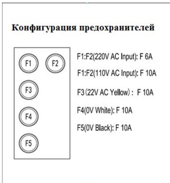
Рис. 5. Блок предохранителей напольного блока подключения
