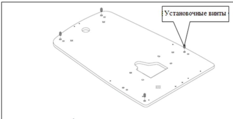
Для того, чтобы выровнять установку по горизонтали, необходимо использовать установочные винты. Установку можно закрепить на полу при помощи болтов.
