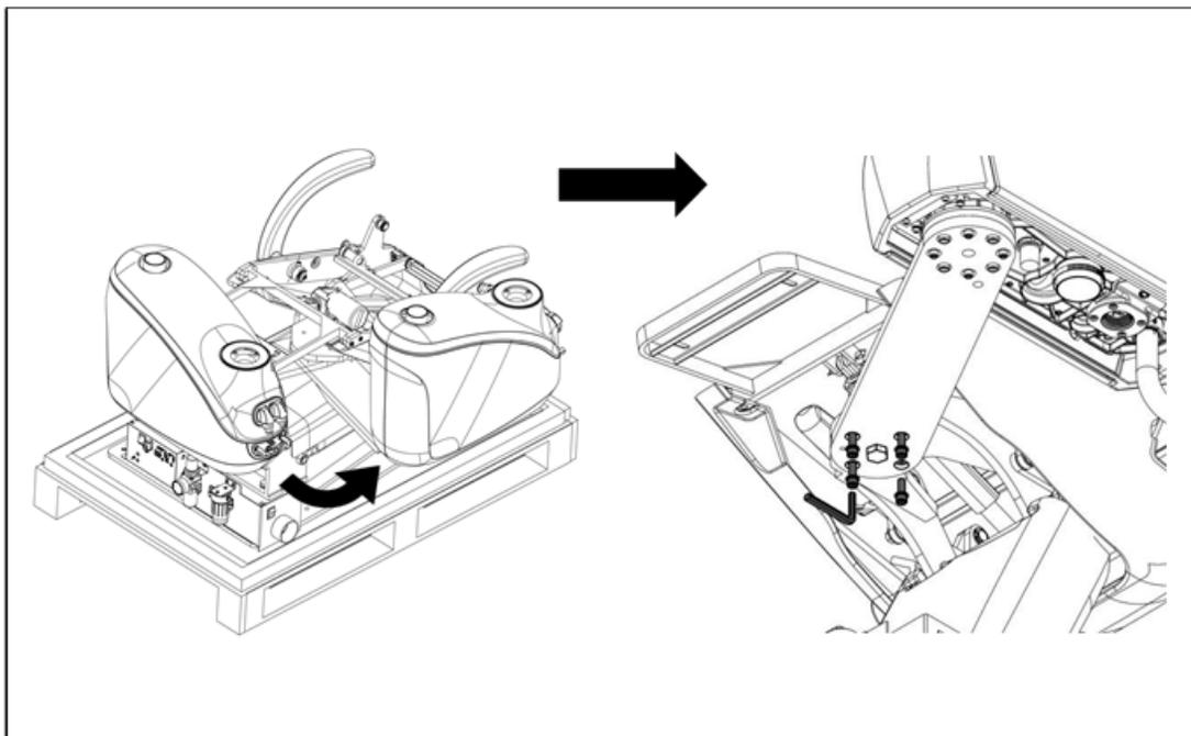
4. Зафиксируйте соединительную пластину на нижней части гидроблока с помощью четырех установочных винтов.
