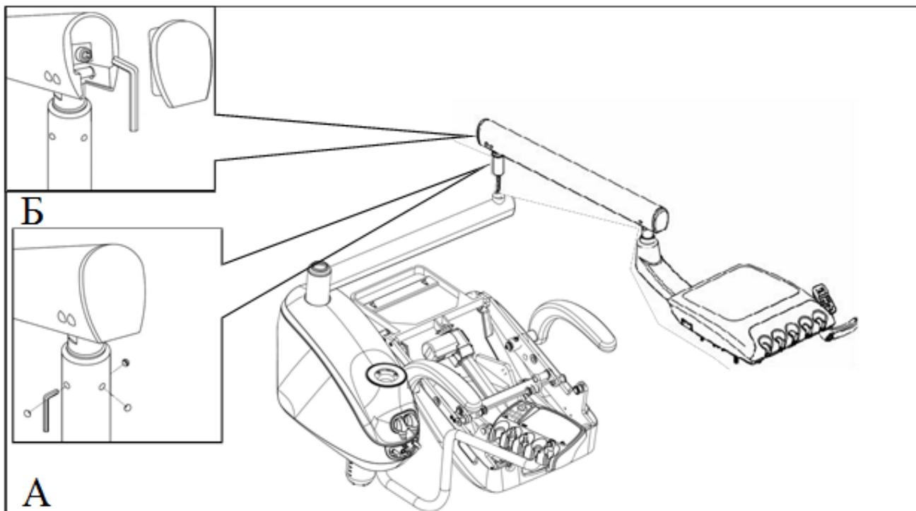
2. Вставьте крепежную ось пантографического плеча модуля врача в фиксирующий паз вращающегося плеча и пропустите электрический шнур и трубки через гидроблок.
