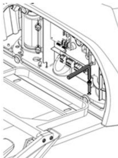
3. Поверните гидроблок в левую сторону от стоматологического кресла и зафиксируйте соединительную пластину к основанию кресла четырьмя винтами.
