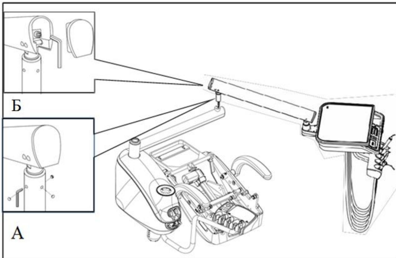
4. Вставьте крепежную ось пантографического плеча модуля врача в фиксирующий паз вращающегося плеча и пропустите электрический шнур и трубки через гидроблок.
