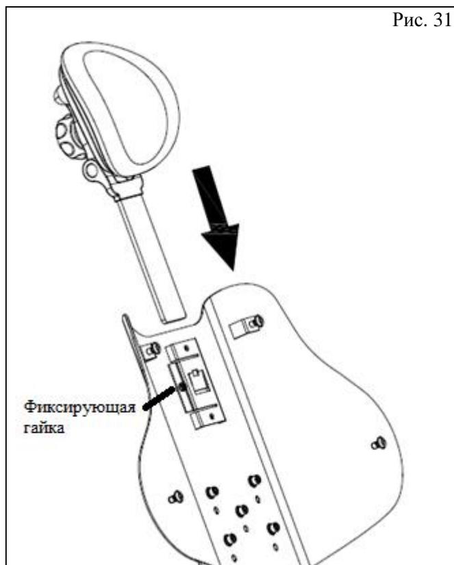
3. Установите обивку спинки кресла на основание спинки кресла. Совместите отверстия на обивке спинки кресла с креплениями на основании спинки кресла. Затем надавите на обивку спинки кресла до упора так, чтобы обивка плотно закрепилась на основании спинки кресла.
