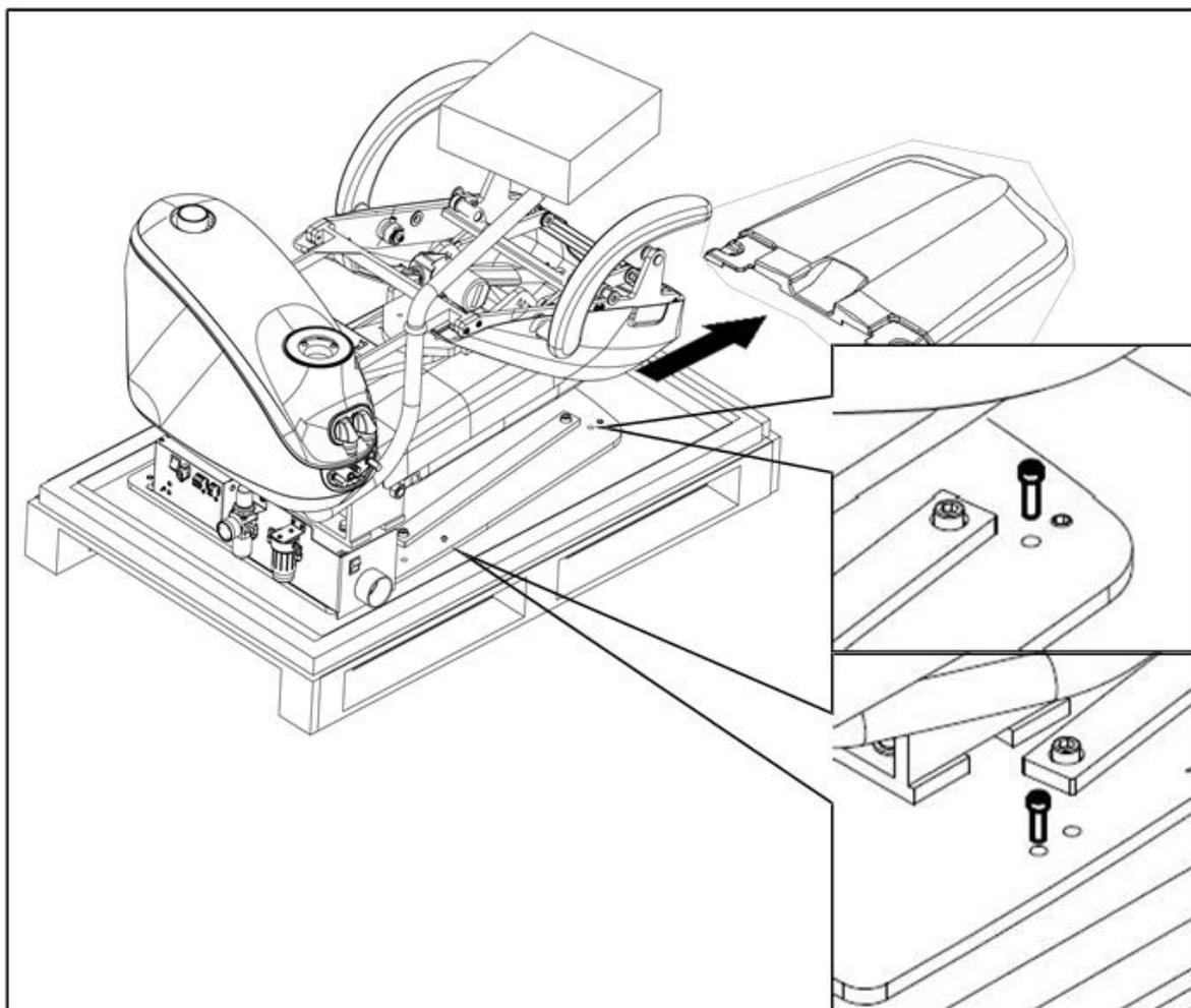
4. Открутите винты, фиксирующие заднюю нижнюю накладку кресла, и снимите ее.
