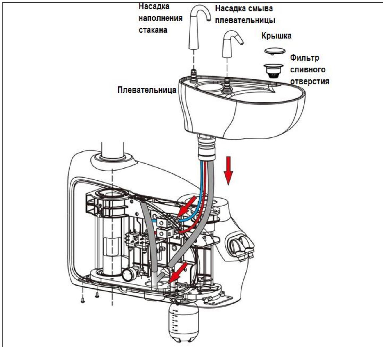
Установите плевательницу, подключите выходы плевательницы к клапанам подачи воды на смыв плевательницы, наполнения стакана и к сливу. К клапанам шланги подключаются в соответствии с цветом подходящих шлангов к вводу клапана. Слив плевательницы подключается к тройнику, находящемуся внутри гидроблока. Установите насадку наполнения стакана и насадку смыва плевательницы, как это показано на рисунке.
