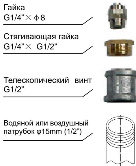
**Рис. 5-1 Описание сборки соединительного патрубка.**
